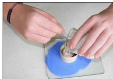
Fot. 9. Wlewanie silikonu na gwiazdę.
