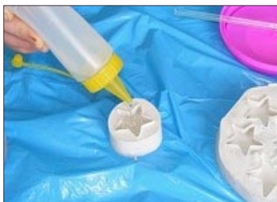
Fot. 15. Wlewanie żywicy do formy.
