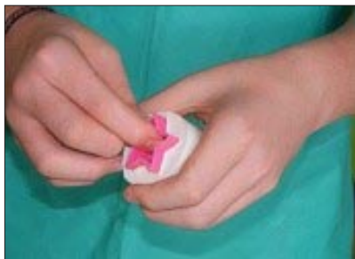
Fot. 11. Wyjmowanie gwiazdy po stwardnieniu silikonu.
