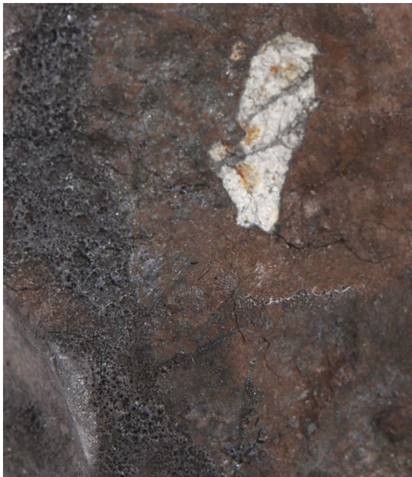
Fot. 1. Skorupa obtopieniowa jest dowodem skrajnie wysokich temperatur wytworzonych przez sprężenie atmosfery wokół i przed meteoroidem. Zdjęcie ukazuje powierzchnię meteorytu kamiennego, na której ablacja dosłownie zagotowała krzemianową skalę. Fot. Paweł Zaręba.
