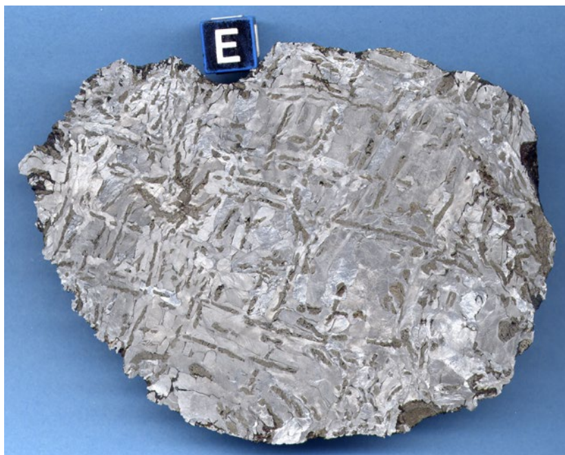
Fot. 8. Wytrawiony przekrój szrapnela z widocznymi deformacjami figur.
