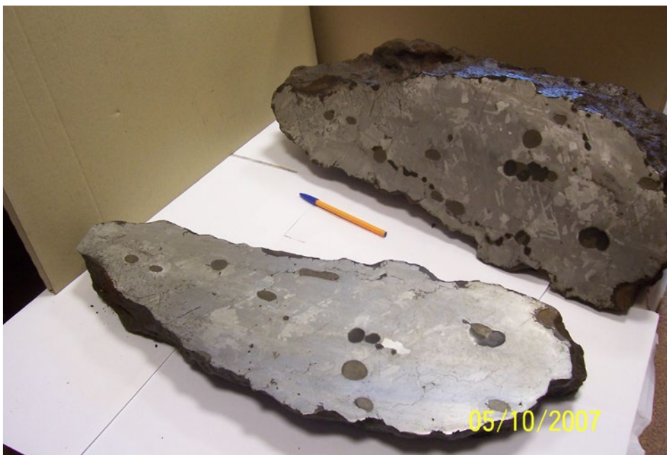
Fot. 4. Morasko 164 kg po przecięciu i wytrawieniu. Część z cohenitem jest z lewej.
