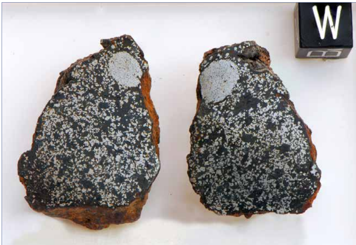
Fot. 1: W mezosyderycie typu A, Dalgara, widać równomiernie rozproszony metal i nodule metalu z krzemianami. Kolekcja Z. Gabelicy. Kostka skali ma bok 1 cm.
